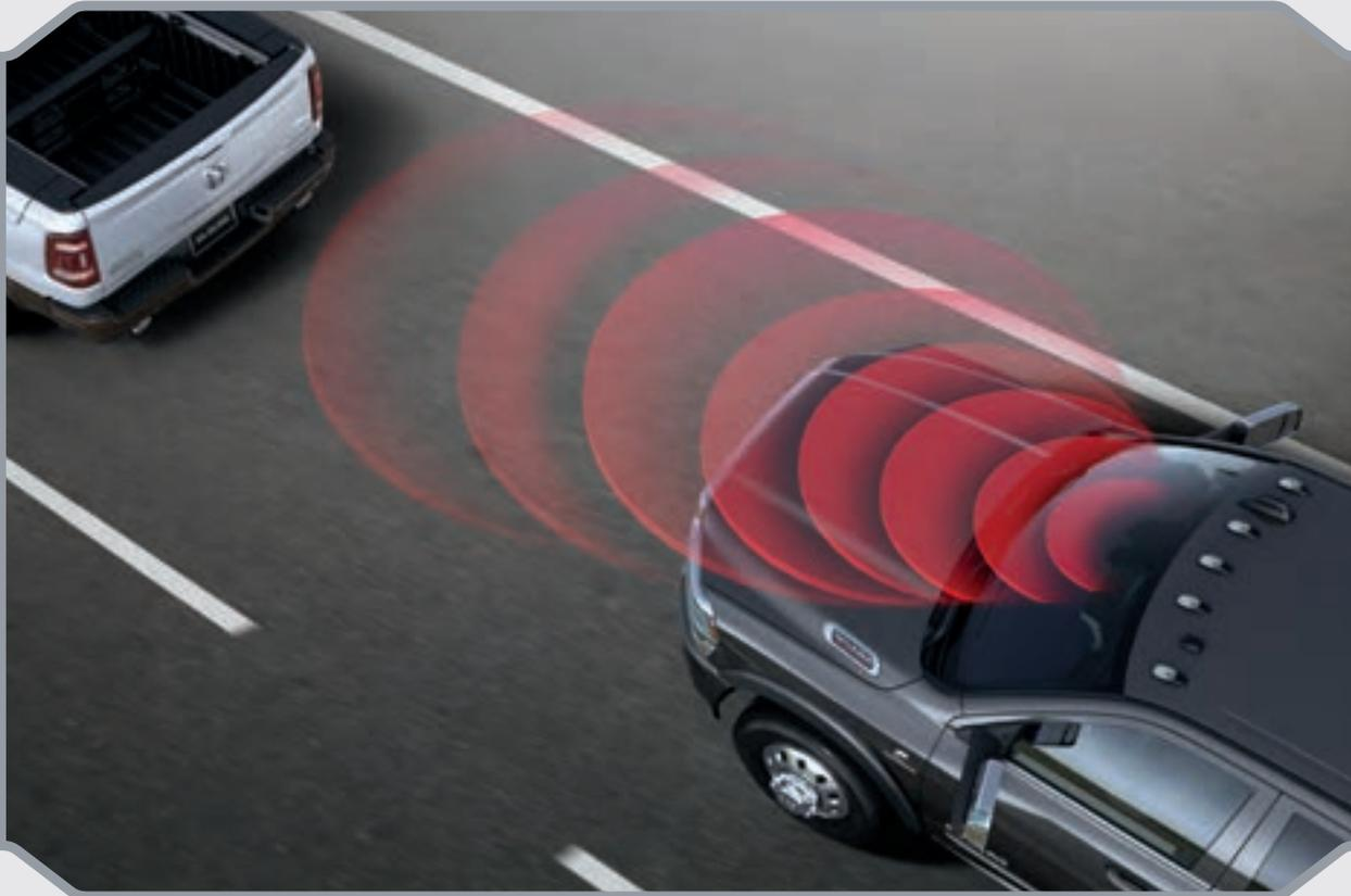
FORWARD COLLISION WARNING WITH ACTIVE BRAKING<sup>23</sup>
